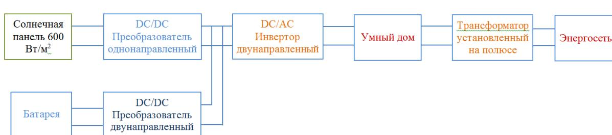
Рисунок 1. Блок-схема системы
